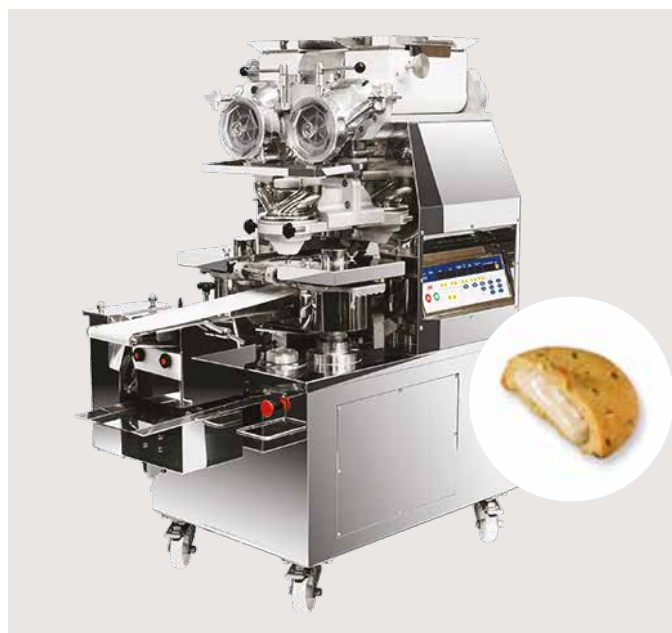
Μηχανή γεμιστών προϊόντων 2 χρωμάτων μοντέλο M-88 Two colour auto encrusting machine model M-88
