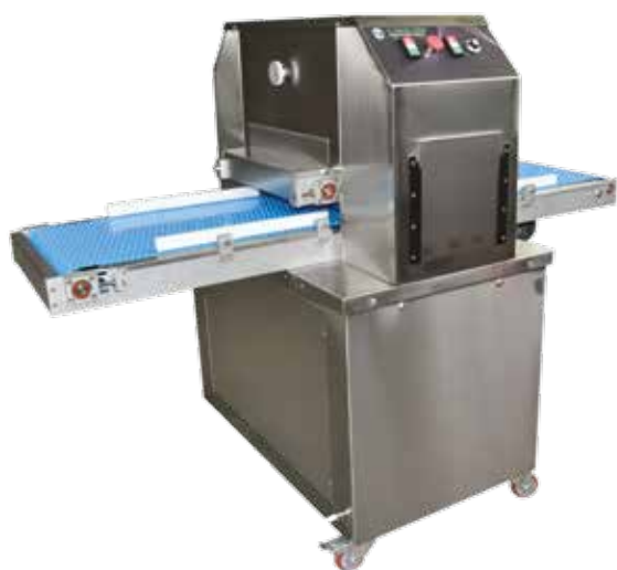
Σχιστικό μηχάνημα παντεσπανιού μοντέλο EDGE R4 Horizontal slice machine for sponge cake model EDGE R4
